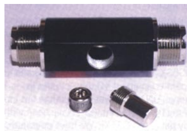
Fot. 2. Rurka gazowo-wyładowcza w ochronniku przepięciowym WATSON/MFJ/DIAMOND jest mocowana za pomocą gwintowanej wtyczki, mocowanej tylko przez dokręcenie palcami
